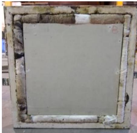
Fotografía 4: Vista de la probeta N°2 antes del ensayo, cara expuesta al fuego.
