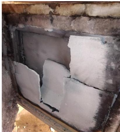
Fotografía 9: Vista de la probeta N°2 por la cara expuesta al fuego, al término del ensayo.
