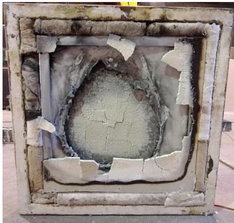
Fotografía 8: Vista de la probeta N°1 por la cara expuesta al fuego, al término del ensayo.
