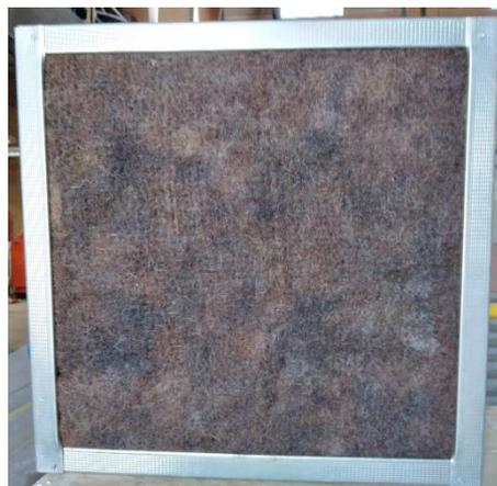
Fotografía 2: Vista del aislante térmico de la Probeta N°2 (Termopelo)
