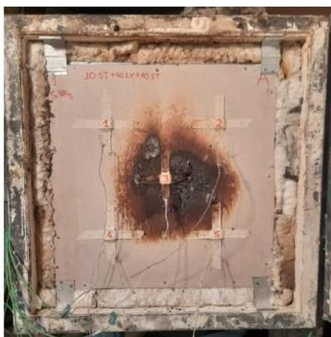
Fotografía 7: Vista de la probeta N°1 por la cara no expuesta al fuego, al término del ensayo.
