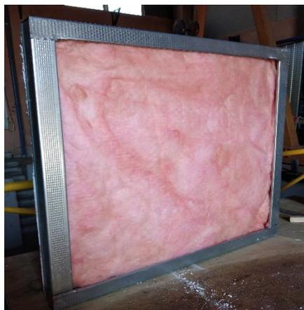
Fotografía 1: Vista del aislante térmico de la Probeta N°1 (lana de vidrio)
