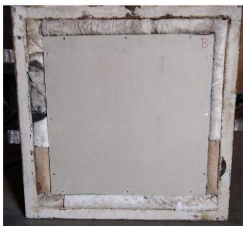
Fotografía 3: Vista de la probeta N°1 antes del ensayo, cara expuesta al fuego.
