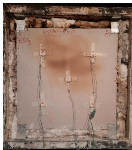
Fotografía 8: Vista de la probeta N°2 por la cara no expuesta al fuego, al término del ensayo.
