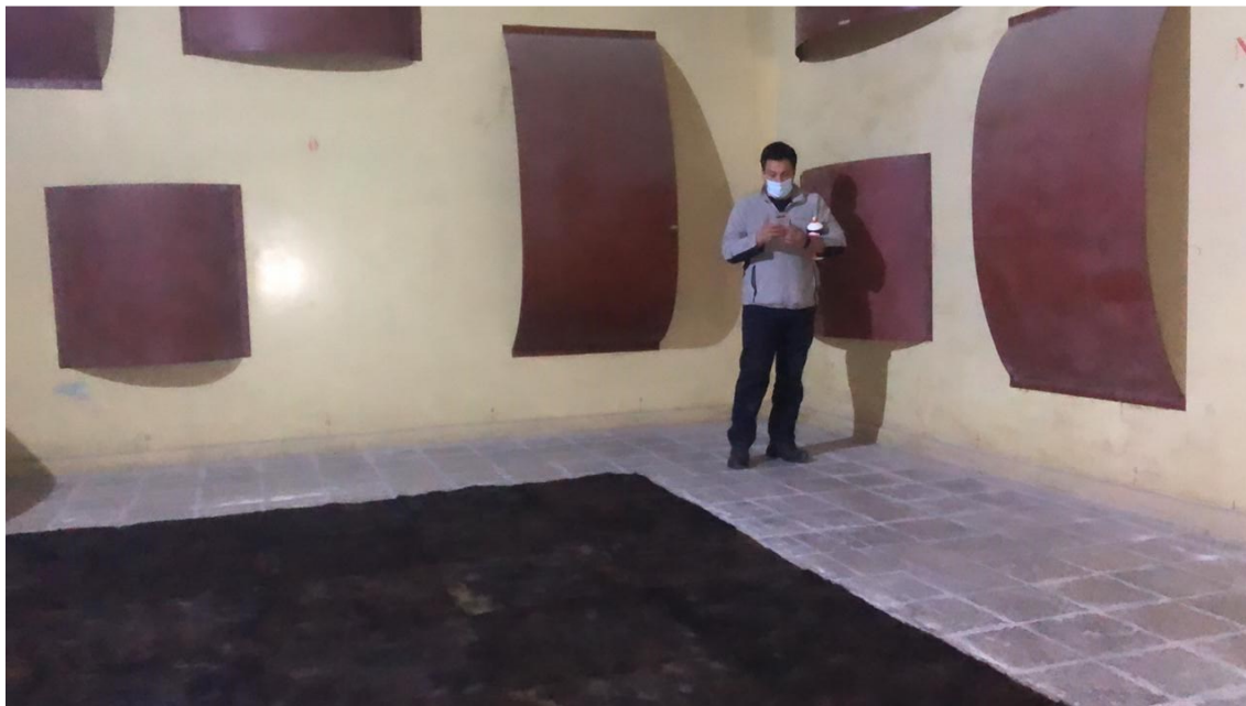
Figura 2 – Vista del montaje de los paneles ensayados en la Cámara Reverberante
