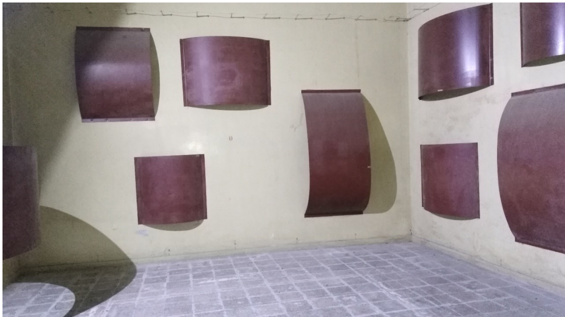
Figura 1 – Vista de Cámara Reverberante de Laboratorio de Acústica de Idiem.
